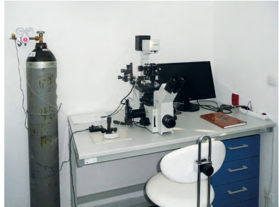
Mikroskop Olympus IX70 s kompletním mikroinjekčním systémem pro přípravu transgenních organismů. © Marta Kostrouchová
